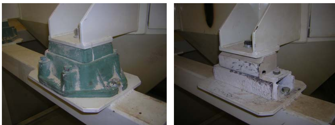
Obr.9 vľavo – pôvodné pružinové tlmiče, vpravo – silentbloky po výmene
